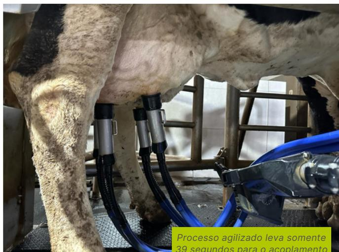
Processo agilizado leva somente 39 segundos para o acoplamento da teteira
